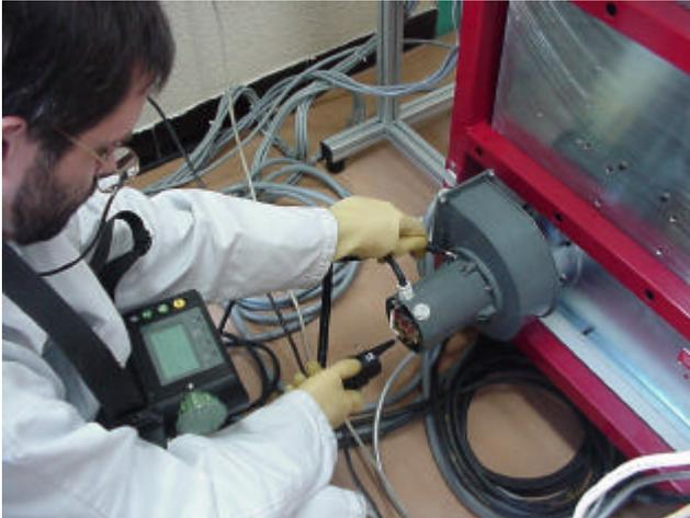
Vérification de l'isolement de partie d'équipement
